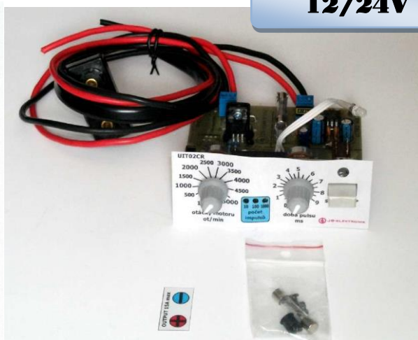
UIT02CR-A přístroj v hliníkovém obalu, UIT02CR-M modul generátoru
