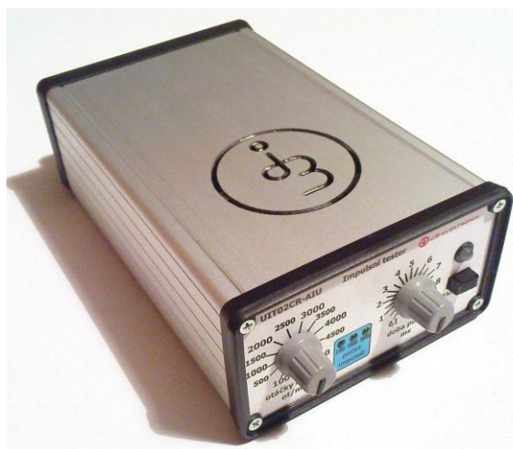
UIT02CR-A přístroj v hliníkovém obalu, UIT02CR-M modul generátoru
