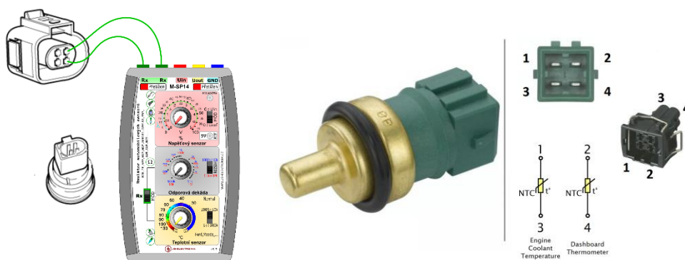
Příklad emulace 4-pinového teplotního senzoru
