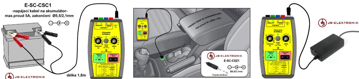
Příklad napájení testera z akumulátoru, autozapalovače a adaptéru
