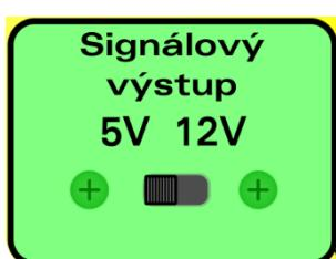
Tester je vybaven i signálovým výstupem **SIGNÁLOVÝ** (+/-), jehož výstupem je PWM signál o přepínatelné **amplitudě 5V nebo 12V**. Tento výstup je možné použít pro řízení akčních členů s vlastním zesilovačem, případně je možné nahradit některé senzory mající napěťový výstup PWM s proměnnou střídou nebo impulsní výstup s proměnnou frekvencí (některé tlakové snímače, měřiče hmotnosti vzduchu, snímače otáček, rychlosti, apod.). Zatížitelnost signálového výstupu je 10mA.
